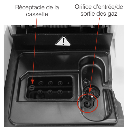
Figure 27. Intérieur de la chambre de mesure
