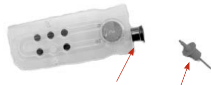
Figure 4. Orifice de remplissage d'échantillon et adaptateur de seringue
