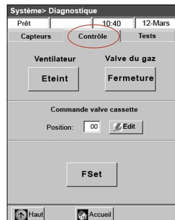
**Figure J-3** : Écran “Système> Diagnostics> Contrôles”
