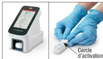
4. Utilisez l'analyseur SNAP Pro\* pour activer automatiquement le test SNAP et interpréter le résultat.
