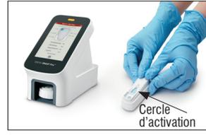
4. Utilisez l'analyseur SNAP Pro<sup>†</sup> pour activer automatiquement le test SNAP et interpréter le résultat.
