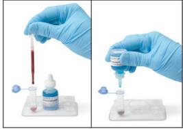
1. À l'aide de la pipette fournie, préparez **3 gouttes d'échantillon** et **4 gouttes de conjugué** dans le tube à échantillon.
