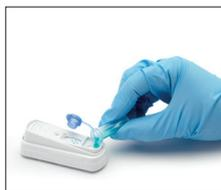
3. Versez l'intégralité du contenu du tube à échantillon dans le puits à échantillon d'un dispositif SNAP 4Dx Plus.
