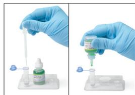
1. À l'aide de la pipette fournie, préparez **3 gouttes d'échantillon** et **5 gouttes de conjugué vert** dans un tube à échantillon.
