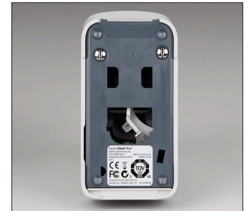
8. Vergewissern Sie sich, dass der Sockel und die silbernen Verschlüsse bündig mit dem Analysegerät abschließen und eingerastet sind. **Wenn Sie den Sockel und die Verschlüsse nicht richtig verriegeln, kann dies die Leistung des Analysegerätes beeinträchtigen.**
