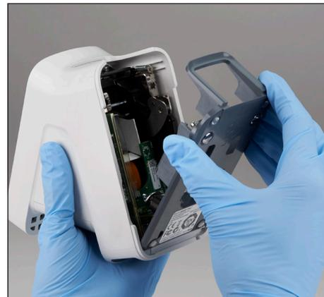
6. Bringen Sie den Sockel nach dem Trocknen wieder am Analysegerät an und vergewissern Sie sich, dass er eingerastet ist.
