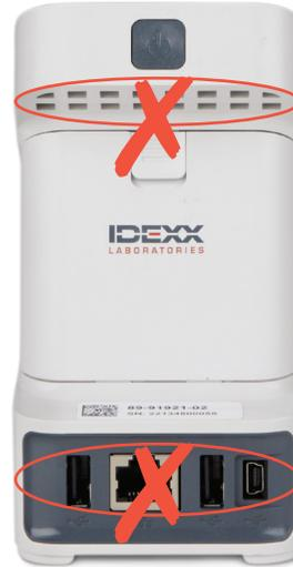
Reinigen Sie das Gehäuse und den Bildschirm mit einem fusselfreien Tuch, das mit 70 % Isopropylalkohol, milder Flüssigseife und Wasser oder einer 10 % Bleichlösung angefeuchtet wurde.
