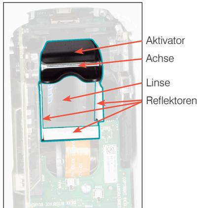
5. Reinigen Sie die 3 weißen Reflektoren, die Achse und den Aktivator mit einem neuen fusselfreien Tuch oder einem Wattestäbchen, das mit 70 % Isopropylalkohol, milder Flüssigseife und Wasser oder einer 10 % Bleichlösung angefeuchtet wurde. **NICHT die Linse reinigen.**
