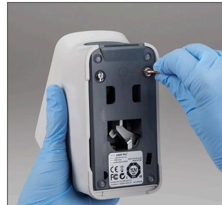
7. Drehen Sie die silbernen Verschlüsse eine Vierteldrehung im Uhrzeigersinn, um den Sockel einzurasten.
