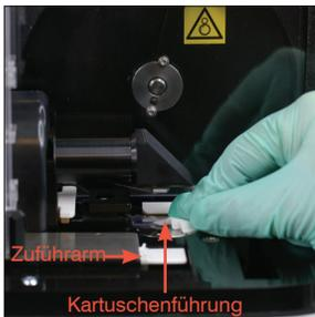
4. Reinigen Sie die Kartuschenführung und den weißen Zuführarm gründlich mit einem neuen Alkoholtupfer. Anschließend mit einem neuen trockenen optischen Reinigungstuch trocknen.
