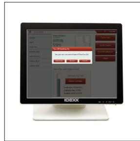
1. Tippen Sie am Monitor auf das SediVue Dx Symbol. Danach auf **SediVue Dx ausschalten** und anschließend auf **Herunterfahren**.
