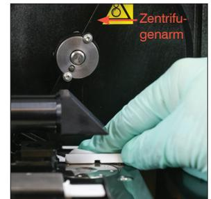
7. Bewegen Sie den Zentrifugenarm vorsichtig nach links und überprüfen Sie den Bereich darunter auf Verunreinigungen. Wenn dieser verschmutzt ist, reinigen Sie ihn mit einem neuen Alkoholtupfer und trocknen Sie sie anschließend mit einem neuen Papierhandtuch.
