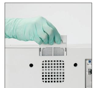
10. Nehmen Sie den Gebläsefilter heraus, spülen Sie ihn gründlich mit warmem Wasser ab, tupfen Sie ihn mit einem Papierhandtuch trocken und setzen Sie ihn wieder in das Analysegerät ein. Tippen Sie dann auf dem Bildschirm SediVue Dx Cleaning Guide auf **Fertig**, um den SediVue Dx einzuschalten.
