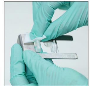
3. Den Kartuschenhalter entfernen, mit einem neuen Alkoholtupfer reinigen, mit einem neuen optischen Reinigungstuch trocknen und anschließend beiseitestellen.
