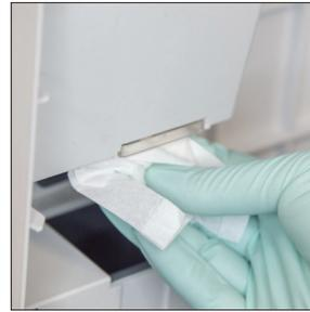
2. Öffnen Sie die Tür des Analysegeräts und reinigen Sie Ober- sowie Unterseite des Messfensters mit einem mit warmem Wasser angefeuchteten optischen Reinigungstuch. Anschließend mit einem trockenen optischen Reinigungstuch trocknen.
