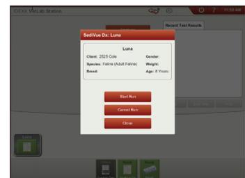
4. Die Tür des Analysegeräts schließen. Sobald das SediVue-Dx-Symbol den grünen Bereitschaftsstatus anzeigt, können Sie im Hauptmenü der IDEXX VetLab\* Station auf das Patientensymbol und dann auf **Durchlauf beginnen** tippen. Eine neue Kartusche wird in das Messfenster eingesetzt.
