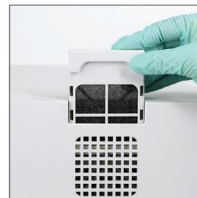
10. Nehmen Sie den Lüfterfilter auf der Rückseite des Analysegerätes heraus, spülen Sie ihn gründlich mit warmem Wasser ab, tupfen Sie ihn mit einem Papierhandtuch trocken und setzen Sie ihn wieder in das Analysegerät ein.
