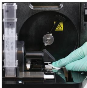
8. Den beweglichen Arm mit einem neuen Alkoholtupfer reinigen und anschließend mit einem neuen optischen Reinigungstuch trocknen.
