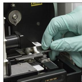
9. Abfallbehälter, Tropfschale, Schutzabdeckung der Zentrifuge und Kartuschenhalter an der richtigen Stelle wieder in das Analysegerät einsetzen.
