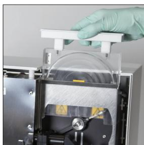
7. Die Schutzabdeckung der Zentrifuge, den Abfallbehälter und die Tropfschale entfernen, mit warmem Wasser reinigen und anschließend mit Papierhandtüchern trocknen.
