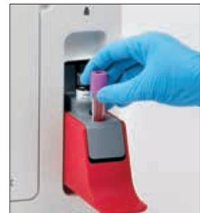
**WICHTIG:** Bei Verwendung eines Mikroröhrchens müssen Sie zuerst die Kappe entfernen, bevor Sie das Röhrchen im Probenfach platzieren.
