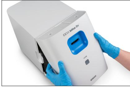
e. Replacez le couvercle avant en insérant les languettes supérieures dans les fentes correspondantes situées en haut de l'analyseur jusqu'à ce que les bords du couvercle et de l'analyseur se touchent. Ensuite, appuyez sur le bas du couvercle jusqu'à ce qu'il s'enclenche.
