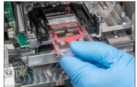
a. Nehmen Sie die Frontabdeckung ab, indem Sie Ihre Finger in die Aussparungen auf beiden Seiten des Analysegerätes legen, nach außen und oben ziehen und dann die Abdeckung oben aushängen.
