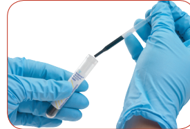
Abbildung 2: Probe mit Pipette aus dem Citrat-Röhrchen (3,2 % Natrium-Citrat) entnehmen.
