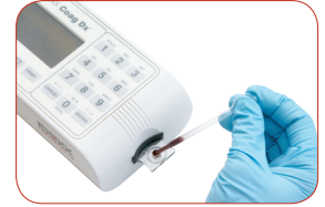
Abbildung 3: Probe in die mittlere Probenvertiefung geben.
