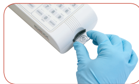
Abbildung 1: Eine Coag Dx PT- oder aPTT-Kassette in das Gerät einlegen.
