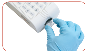
Abbildung 1: Eine Coag Dx Citrat PT- oder Citrat aPTT-Kassette in das Gerät einlegen.
